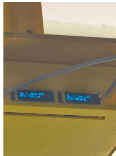
OLED에 거리값 실시간 표시 (mm)
