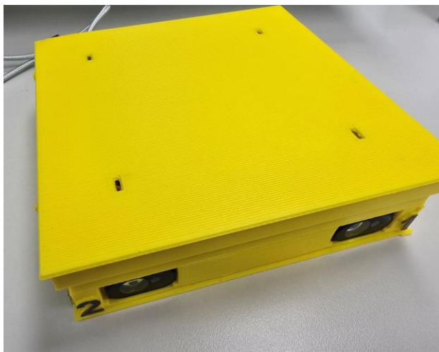
3D 프린팅 하우징 (센서 2개 내장)
